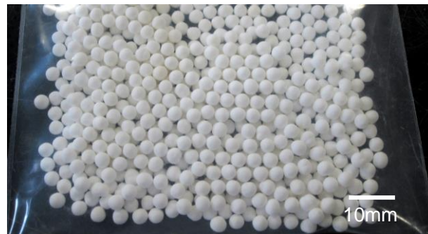
図5 マルメライザーにて作製した球体 (成形体)
