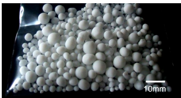
図 1 ハイドロタルサイトのみで作製した球体 (成形体)
