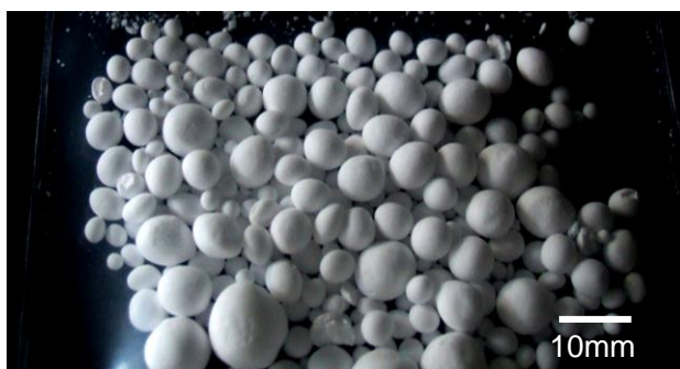
図 2 ハイドロタルサイトのみで作製した球体 (焼成体)
