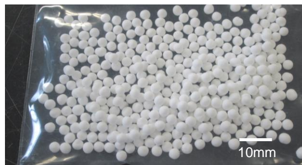
図6 マルメライザーにて作製した球体 (焼成体)
