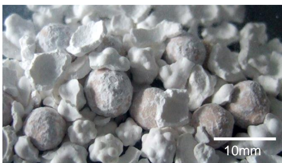
図4 素焼きの球体を混合して作製した焼成体
