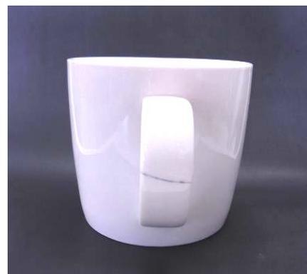
図 13 中心方向打撃の場合の破損状況
