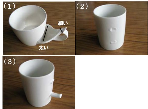
図10 カップハンドルの破損状況
