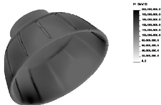
図 5 落下時の応力分布(衝突後 200 μ sec)
