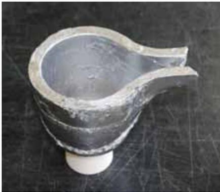
図5 溶解炉に浸漬させたラドル
