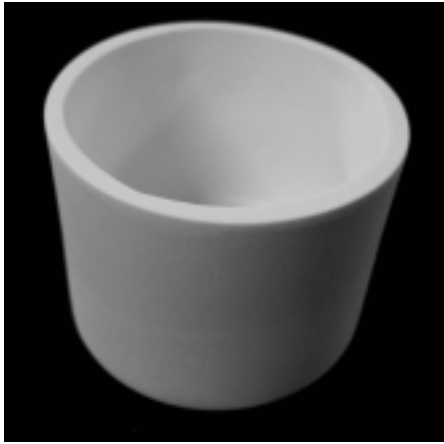
図5 マイクロ波焼成で作製したルツボ
