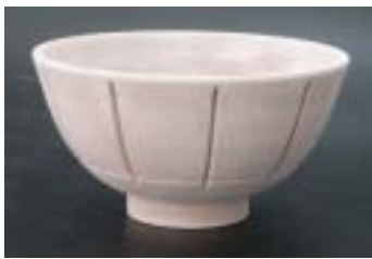
図2 割れ誘導線 10本モデルの原型
