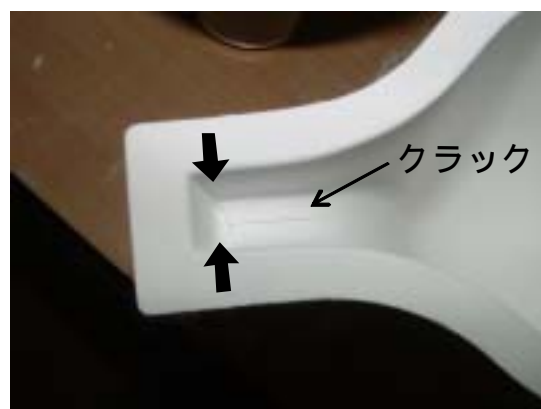
図3 成形時に発生したクラック
