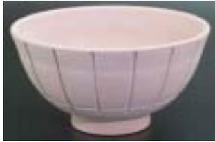
図 2 割れ誘導線 16 本モデルの原型
