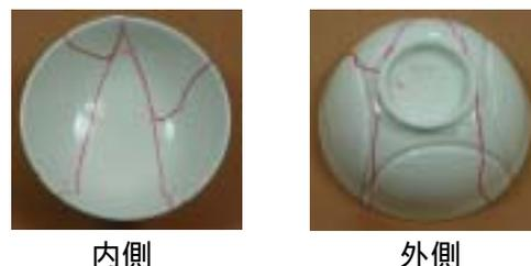
図 4 試作品 1 の落下試験後の割れ状況
