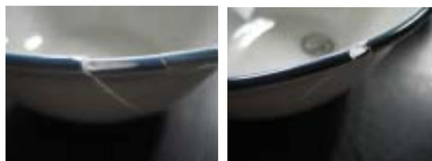
図3 衝撃試験による破損状況の一例.
