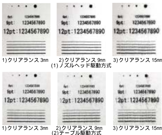
図5 クリアランスの影響(印刷速度:100mm/sec)
