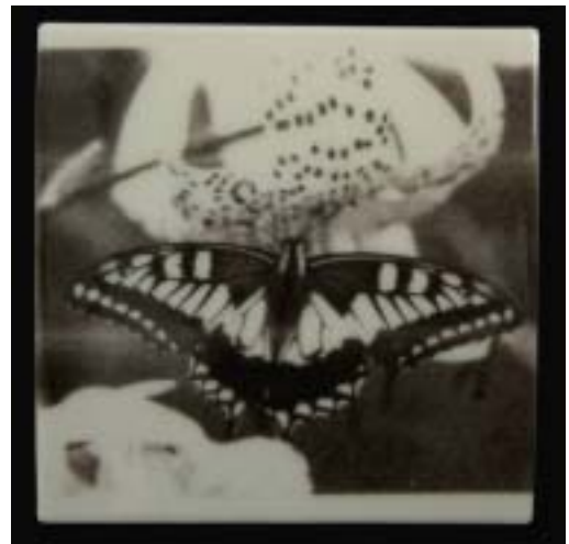
図5 水熱処理により合成した粉末を用いてインクジェット印刷したタイル(ブラック)
