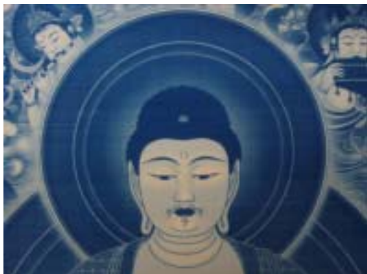
図9 4回重ね印刷による試作品（15dotピッチ）
