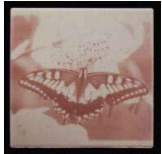
図4 水熱処理により合成した粉末を用いてインクジェット印刷したタイル(マゼンタ)
