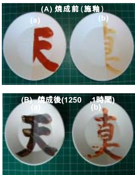
図5 \alpha\text{-Fe}_2\text{O}_3\text{-ZrO}_2 粉末を用いて作製した試作品
