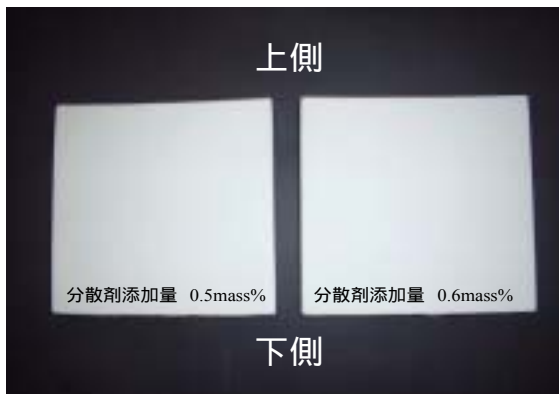
図3 1600 で焼成した角盤の外観写真
