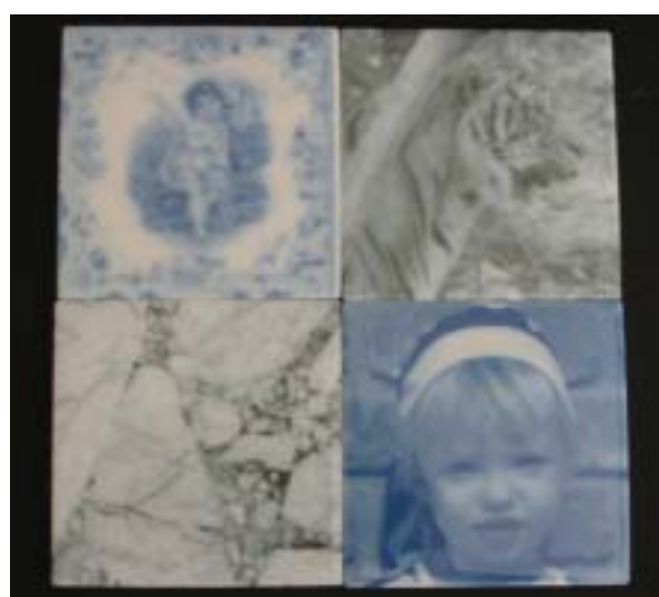
図8 ピエゾ式インクジェット印刷したタイルの試作品
