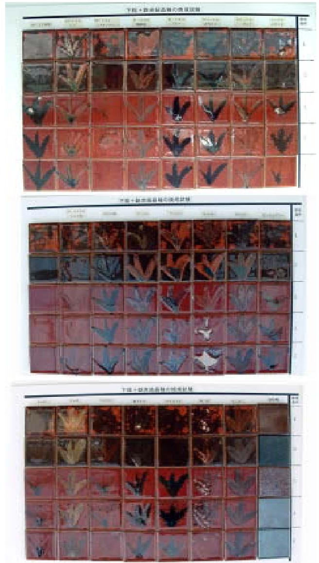
図 2 鉄赤釉の調製試験片
