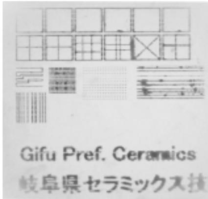
図5 インクジェット印刷焼成体
