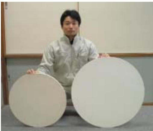
図 5 大型円盤(600mm × 30mm(左)、750mm × 22mm(右))のマイクロ波焼成体
