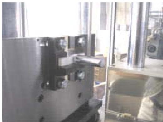
図1 平板測定用治具を設置した衝撃試験機
