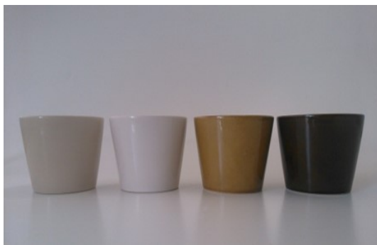
開発した透明釉とその多色化 (透明、乳白、薄飴、飴)
