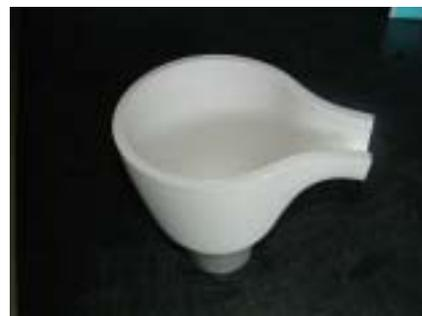
チタン酸アルミニウム製部材
