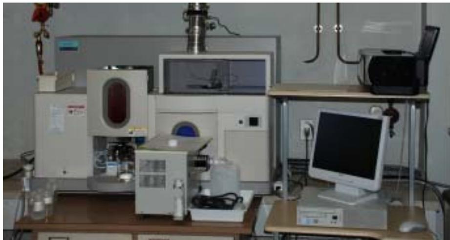
本装置は陶磁器、ガラス及びホウロウ引き製品等から溶出するPb、Cdをはじめ、セラミックス等の原料や製品中の微量成分について定量分析を行うことができます。特に、フレイムレスによる高精度の分析が可能となり、国内の食品衛生法はもとより、国際標準規格(ISO)、米国FDA、及び米国カルフォルニア州 Proposition65 にも対応可能です。
