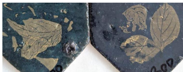
図2 異なる温度で焼成した金箔装飾試験
