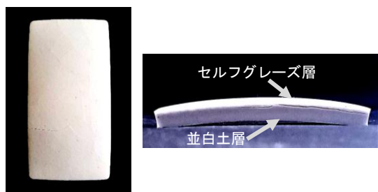
図 2 ゼーゲル式を用いて原料調合したタイル 左：上面外観、右：側面外観
