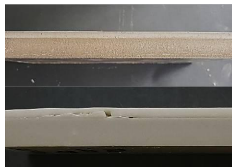
図6 ステッププレス法で作製したタイル 上：成形体、下：焼成体
