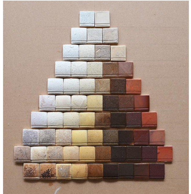
図 4 栗皮釉焼成結果（磁器素地）
