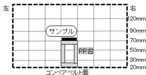
図3 開口部（導入側）からみた試験エリアおよび測定模式図
