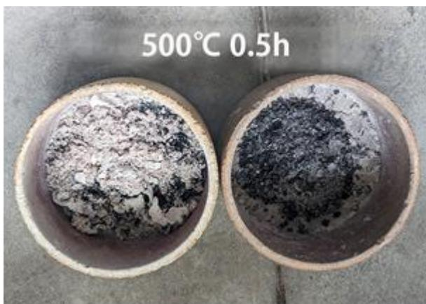
図3 電気炉の蓋を開けて焼成した結果
