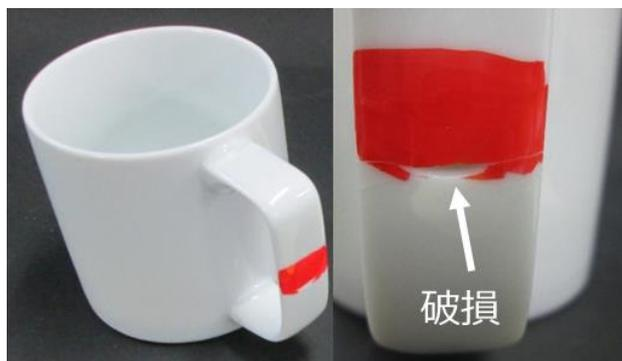
図5 代表的な破損パターン(ハンドル中央部分)
