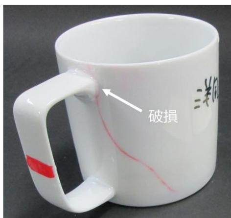
図6 代表的な破損パターン(ハンドル接続部分)
