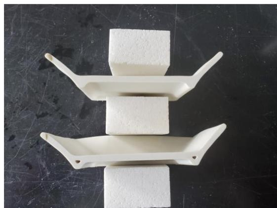
図9 圧力0.20MPaで作製した焼成体断面写真 (スラリー温度: 上 5°C、下 40°C)
