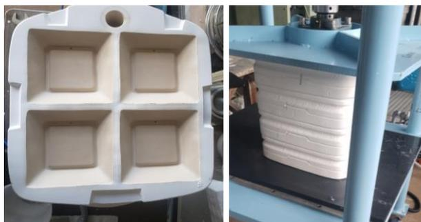
図2 使用した石膏型(左)と段積みした様子(右)
