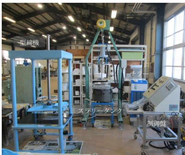
図1 本実験で使用した圧力鑄込み装置(外観)
