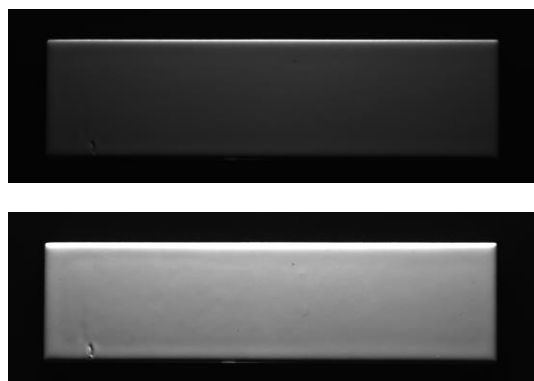
図5 各シャッタースピードによる静止画像 (上：レンズ絞りを全開で 1[msec] 下：適切なレンズ絞りで 10[msec])
