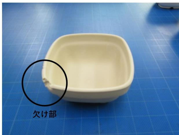
図 4 圧力鑄込み試験失敗例
