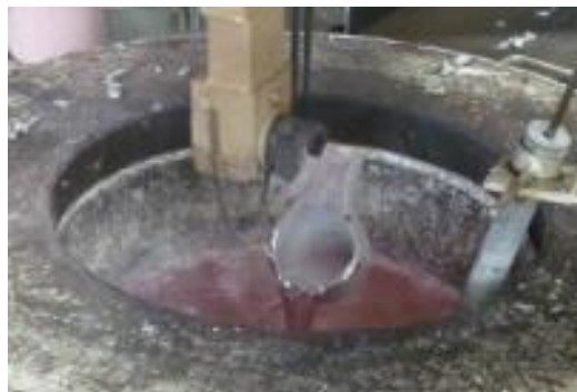
ダイカストマシンに組み込まれ、アルミニウム溶湯を運搬するラドル
