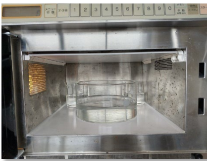
電子レンジのマイクロ波出力校正の様子
