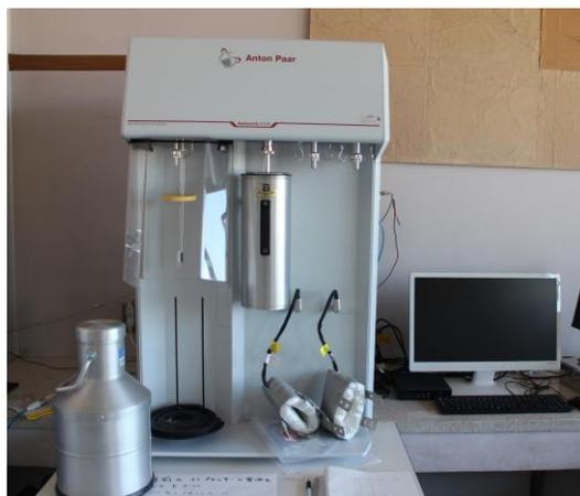
ガス吸着測定装置の外観
